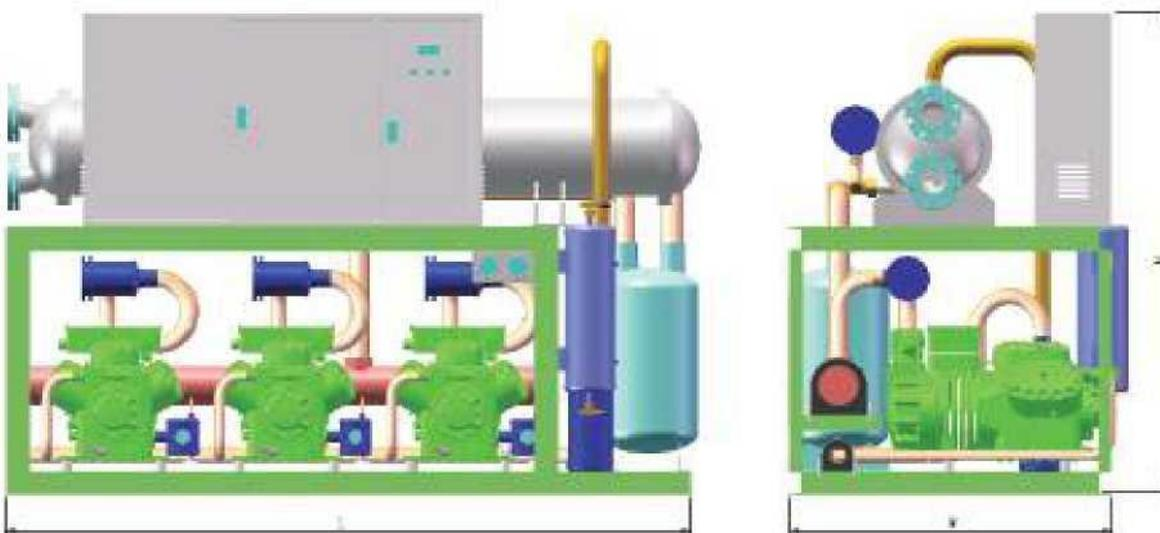
Конденсационная установка с четырьмя параллельными компрессорами
